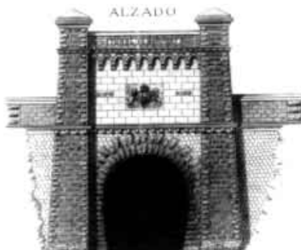
Alzado original de la boca sur (la de España) del túnel de Somport.
